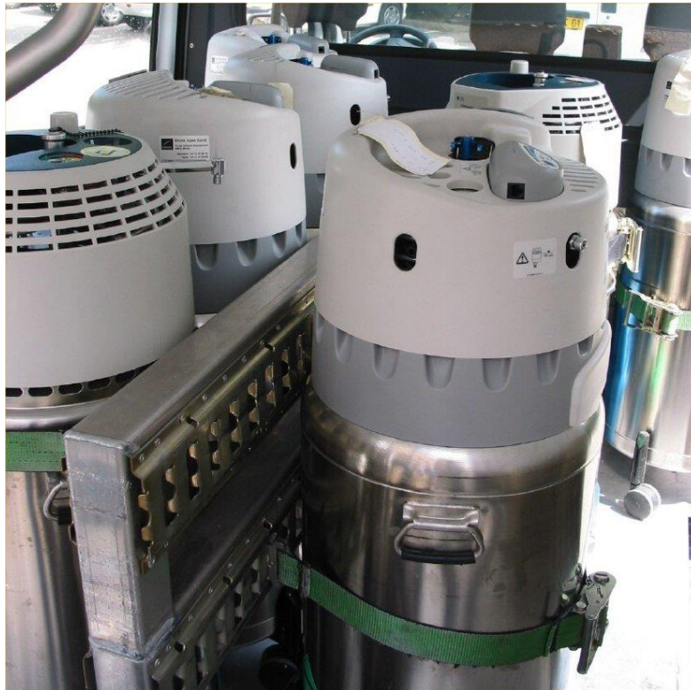
Fig. 4 Ségrégation typique de réservoirs de liquide avec les pleins et le vides sécurisés séparément
