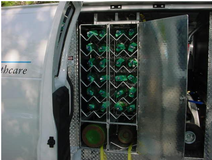
Fig. 2 Rack de stockage de bouteilles typique dans un véhicule de livraison
