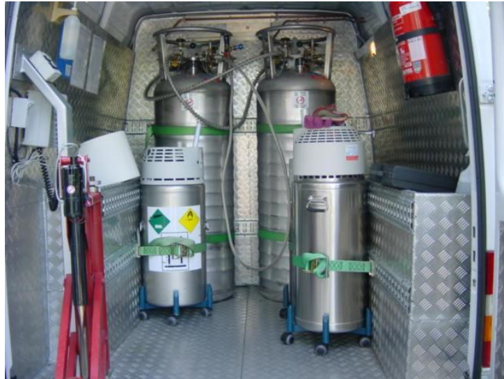
Fig. 3 Stockage de réservoirs de liquide avec l'arrimage typique dans un véhicule de livraison
