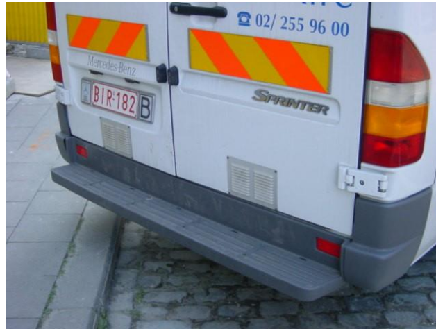
Fig. 1 Grille de ventilation typique en bas de la porte arrière du véhicule de livraison
